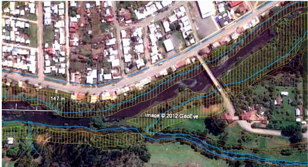
Figura Nº 26: La imagen adjunta muestra las áreas definidas cartográficamente como afectas a procesos de inundación.
