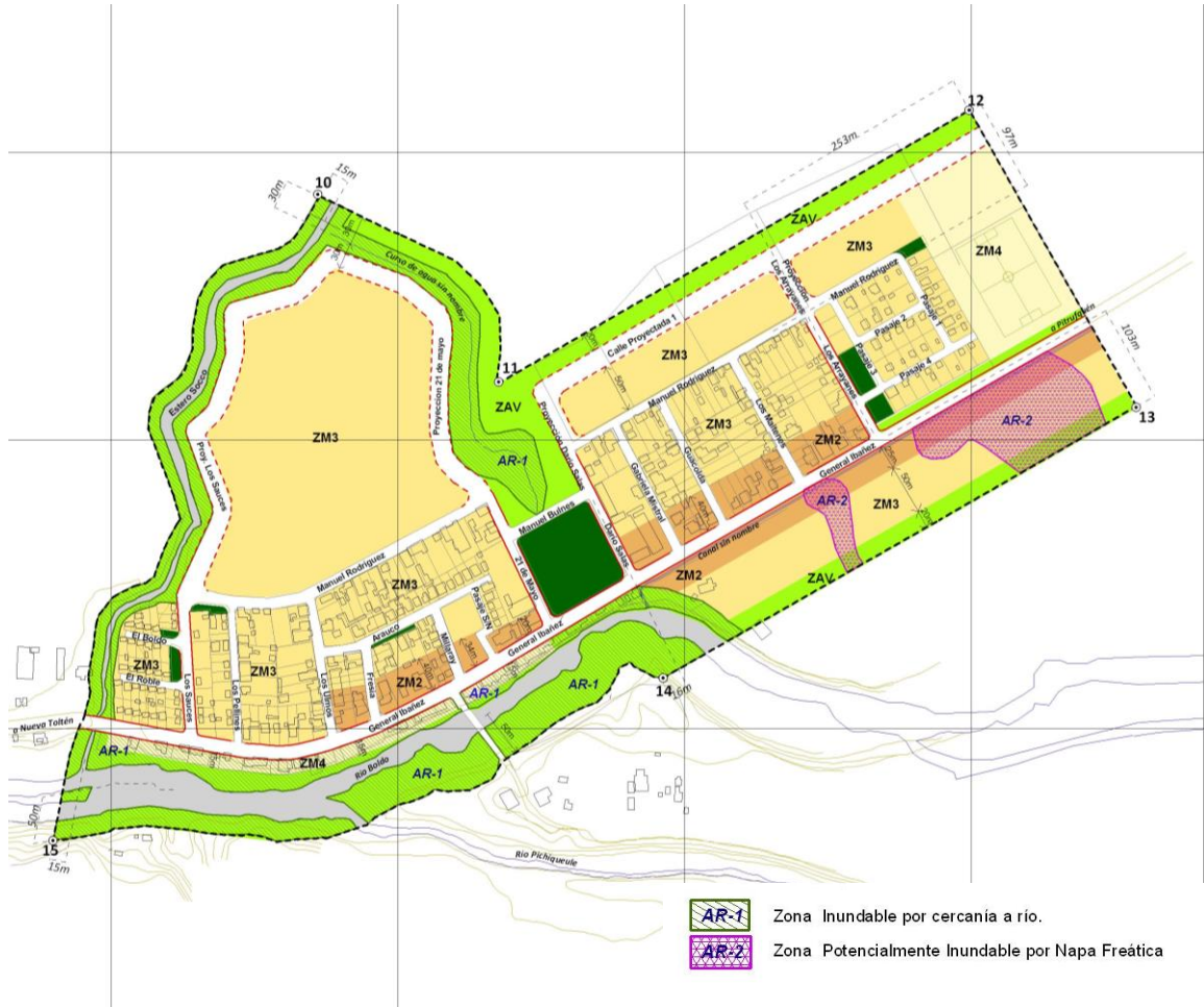
Figura Nº 24: Localidad de Los Boldos, esta se emplaza sobre terraza fluvial y llanura de inundación, presentando procesos de inundación por cercanía al río y potencialmente inundables por napa freática.
